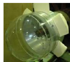
波力発電用タービン装置
