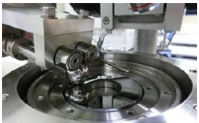
図2 ボールオンディスク型摩擦試験機
