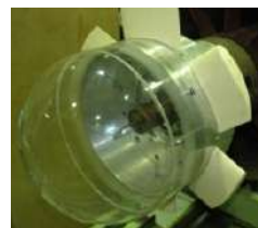
波力発電用タービン装置
