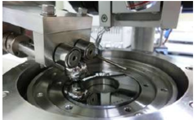
図2 ボールオンディスク型摩擦試験機
